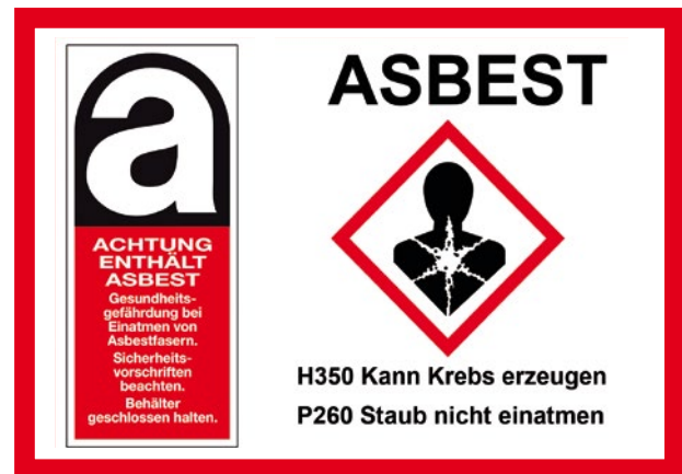
Beispiel für die Kennzeichnung von Asbestverpackungen
