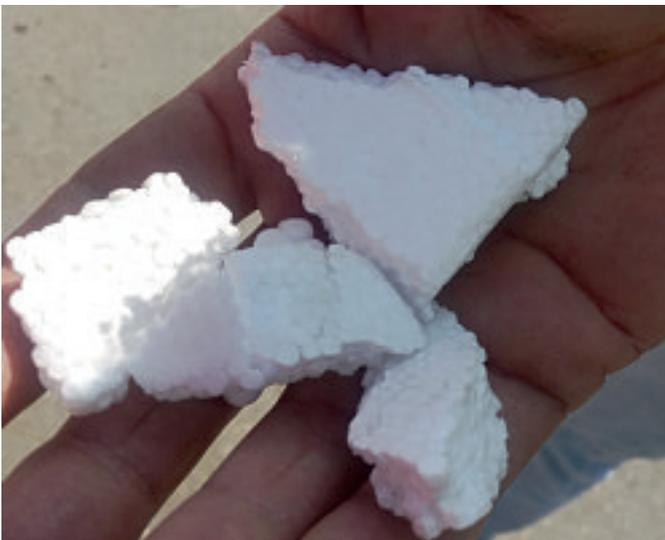
Styropor mit Kugelstruktur kann gut recycelt werden
