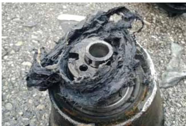
Foto: So können Feuchttücher, Binden, Fetzen, Tampons,... die Pumpen in der Kläranlage verstopfen!
