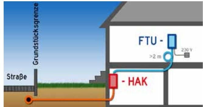
Grafik: Im Innenbereich sollten vorerst mindestens 2m Glasfaserleerrohr belassen werden. In späterer Folge wird der HAK (Hausanschlusskasten) und eine FTU-Einheit dazu montiert.
