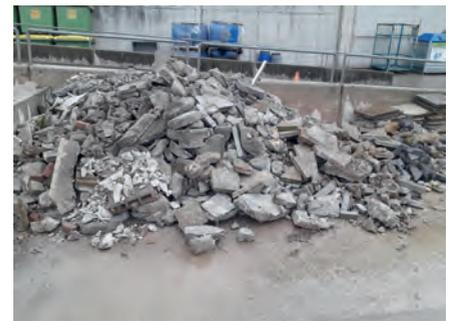
Betonabbruch, als beste Baurestmassen-Qualität, wird entweder zu Betongranulat und Recyclingbeton weiterverarbeitet oder auch für Tragschichten, Drainageschichten, Wegebau und hochwertige Künettenverfüllungen verwendet.
