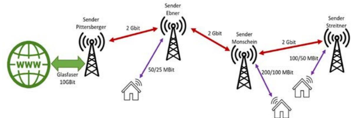
Bild 3: Schematische Darstellung „Grabenfunk“
