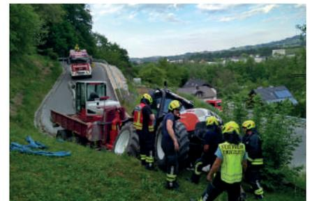
Nach der Lageerkundung wurde der Traktor umgehend mittels Greifzug gegen ein Umstürzen gesichert. Parallel dazu das Gespann zusätzlich mit der Seilwinde gesichert und eine provisorische Rampe aus Pölzholz gebaut, auf der der Traktor schließlich gesichert zurück auf die Straße geleitet werden konnte. Anschließend wurde das Gespann noch gesichert auf ein flacheres Straßenstück begleitet, von wo es die Fahrt selbständig fortsetzen konnte und die Feuerwehr abrücken konnte.
