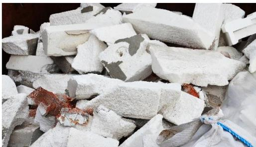
Weißer bzw. graue Dämmplatten auch bekannt als EPS (expandiertes Polystyrol) Platten werden ebenso für Renovierungs- und Sanierungsarbeiten an Fassaden, Kellern, Dächern oder Bodenplatten von Gebäuden eingesetzt. Das EPS ist zwar als „nicht gefährlicher Abfall“ eingestuft worden wird aber dennoch zukünftig am ASZ verboten sein.
