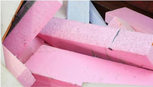
Färbige Dämmplatten aus XPS (extrudiertes Polystyrol) werden umgangssprachlich auch „Styrodur“ genannt. Sie dienen als Wärme- und Feuchtigkeits-Isolierung beim Hausbau. Anders als bei Styropor (Kügelchen) wurde XPS bis 2004 im Inland (Importe bis 2009) mit FCKW aufgeschäumt bzw. mit brandhemmenden Mitteln ausgestattet. Eine Untersuchung zeigte, dass die verwendeten
