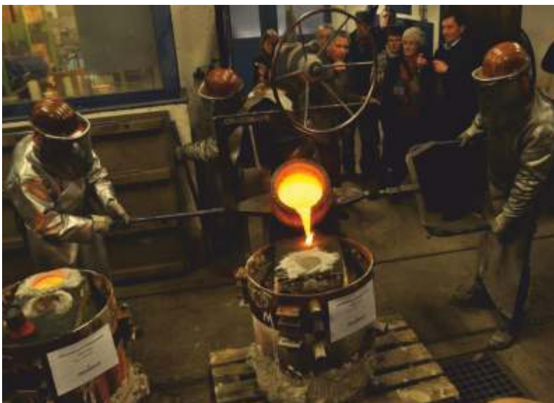
Beim Guss der zweiten Glocke.
