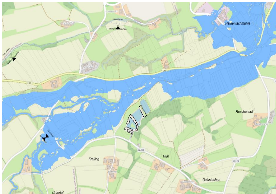
Abbildung 1: Gefährdungen durch Hochwasser 30 und rote Gefahrenzone (blau signierte Flächen zwischen Gemeindegrenze zu Euratsfeld und Perbersdorf am Zauchbach bzw. Elzbach) und unbebaute Baulandflächen (schwarz strichliert)
