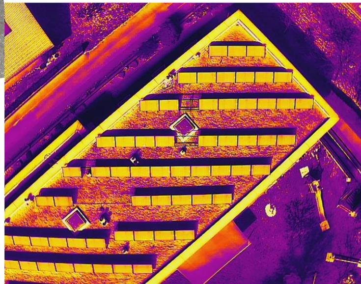
Bei diesem Flug wurde kontrolliert, ob jedes Modul der Photovoltaikanlage funktioniert. Tatsächlich konnte aufgrund der Wärmebildaufnahme ein kleines kaputtes Teil bei einem Modul gefunden werden.
