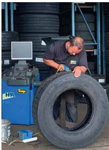
Werner Viehböck beim Vulkanisieren von LKW Reifen.
