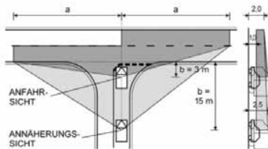
Abbildung 29: Schemaskizze eines Sichtfeldes im Knoten
