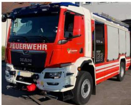
Bei dem neuen Fahrzeug handelt es sich um ein Hilfeleistungsfahrzeug 2 (HLF2) auf einem 15t-Fahrgestell der Marke MAN mit 320 PS © Symbolfoto
