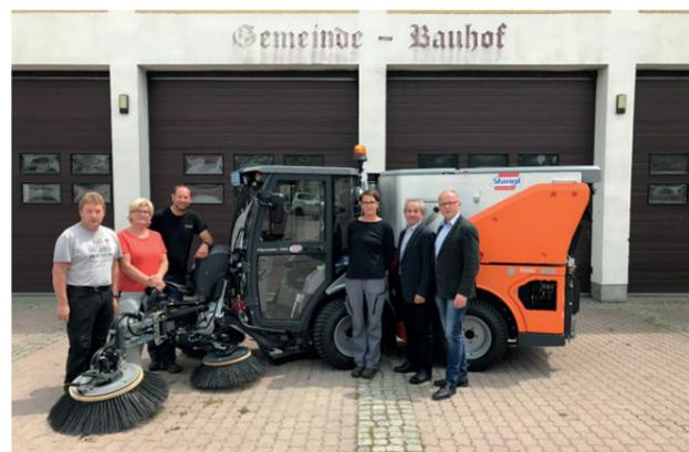
Es handelt sich dabei um einen Geräteträger, einem Knicklenker mit sehr hohen Bedien- und Fahrkomfort in der 3,5 t Klasse (B-Führerschein). Er ist sehr wirtschaftlich, da die Anbaugeräte wie Kehren, Mähen, Schlegeln, Tanksystem, Schneepflug und Streuer in nur wenigen Minuten ohne Werkzeug von nur einer Person gewechselt werden können. Dadurch ist man im Arbeitsablauf sehr flexibel (die verschiedensten Wetterlagen und Arbeitszeiten können besser ausgenutzt werden).
